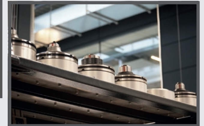
Für die Fertigung von unterschiedlichen Gehäusen stehen 18 Spann-Sets, bestehend aus Spannkopf mit Anschlag, zur Verfügung.
