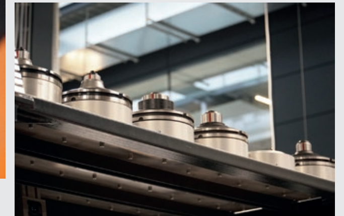
Für die Fertigung von unterschiedlichen Gehäusen stehen 18 Spann-Sets, bestehend aus Spannkopf mit Anschlag, zur Verfügung.
