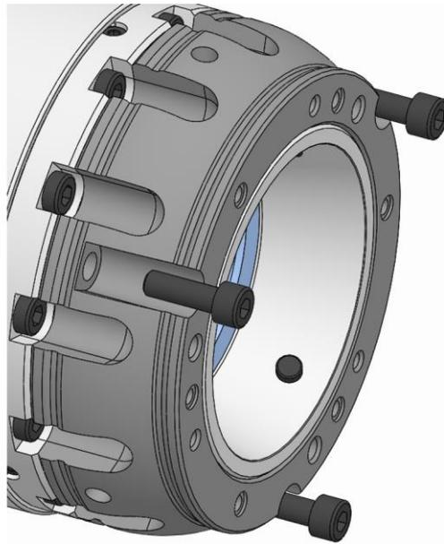
2. Die Befestigungsschrauben Adaptionssring einschrauben und diese mit dem vorgeschriebenen Anzugsdrehmoment festziehen [siehe Kapitel »Schraubenanzugsdrehmomente«].
