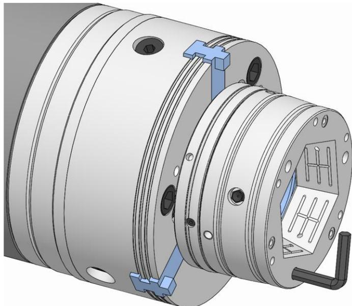
5. Die Befestigungsschrauben Adaptionsspannmittel lösen.
