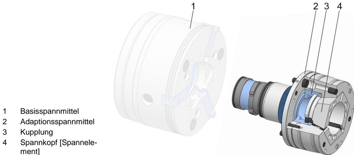
Das Adaptionsspannmittel ist für variierende Außenspannungen des Basisspannmittels vorgesehen.
