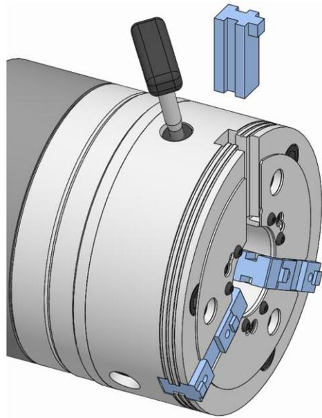
4. Die Schutzbacke bis zur Markierungslinie einsetzen.
