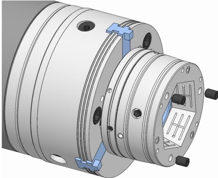
4. Die Gewindestifte Adaptionsspannmittel lösen und entfernen.
