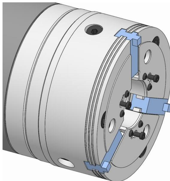
8. Die Befestigungsschrauben Einsatzbüchse lösen und entfernen.
