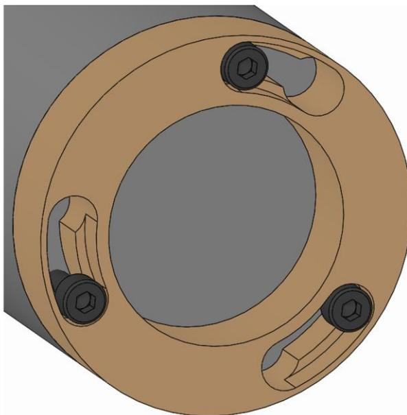
2. Das Wechselteil verdrehen, sodass der Schraubenkopf der Befestigungsschraube Wechselteil durch die Bajonettöffnung passt.
