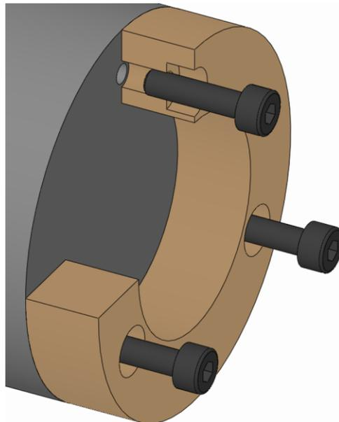
1. Die Befestigungsschrauben Wechselteil lösen und entfernen.
