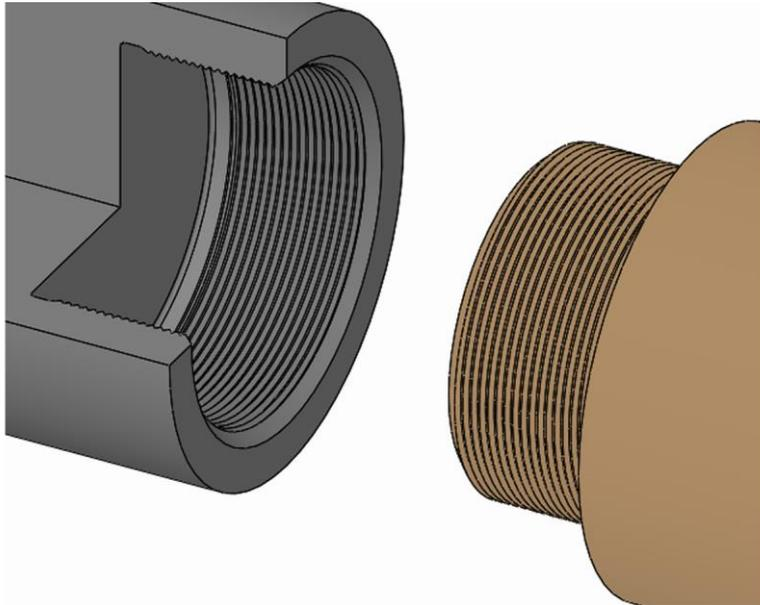
1. Das Wechselteil über dessen Gewinde in das Produkt einschrauben und festziehen.
