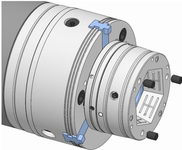
8. Die Gewindestifte Adaptionsspannmittel einschrauben und diese mit dem vorgeschriebenen Anzugsdrehmoment festziehen [siehe Kapitel »Schraubenanzugsdrehmomente«].
