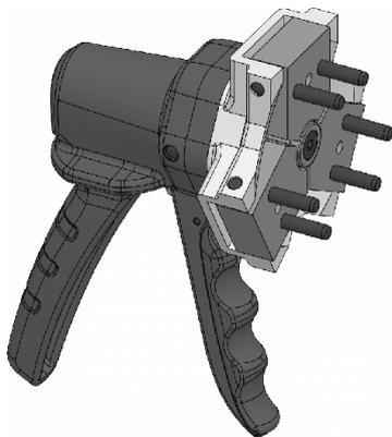
Die Stifte der Wechselvorrichtung werden in die Wechselbohrungen im Spannkopf eingesetzt. Die Wechselvorrichtung wird mittels Handkraft betätigt. Je nach Baugröße ist die Wechselvorrichtung für eine Ein- oder Zweihandbetätigung ausgelegt. Der Spannkopf ist fest in die Wechselvorrichtung eingespannt und kann mit Hilfe der Wechselvorrichtung in das montierte Spannmittel eingesetzt werden.
