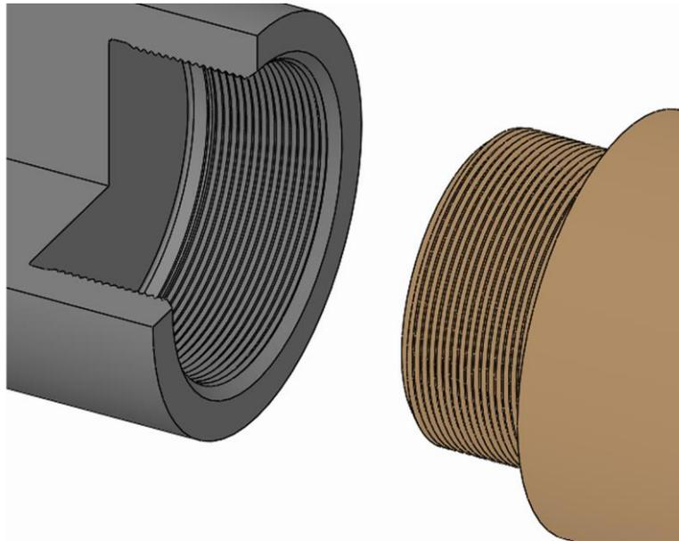
1. Das Wechselteil über dessen Gewinde aus dem Produkt herauserschrauben.
