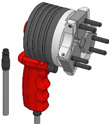
Die Stifte der Wechselvorrichtung werden in die Wechselbohrungen im Spannkopf eingesetzt. Die Wechselvorrichtung wird mittels Druckluft betätigt. Je nach Baugröße ist die Wechselvorrichtung für eine Ein- oder Zweihandbetätigung ausgelegt. Der Spannkopf ist fest in die Wechselvorrichtung eingespannt und kann mit Hilfe der Wechselvorrichtung in das montierte Spannmittel eingesetzt werden.
