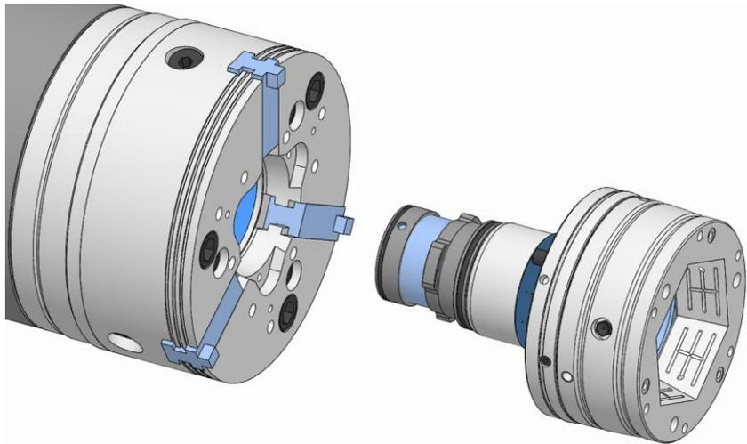
5. Das Adaptionsspannmittel auf das Basisspannmittel aufsetzen, sodass die Bajonettnasen am Adaptionsspannmittel und die Bajonettöffnungen im Basisspannmittel übereinstimmen. Dabei muss der Zylinderstift im Adaptionsspannmittel um  $60^\circ$  verdreht zur Positionierbohrung im Basisspannmittel sein.
