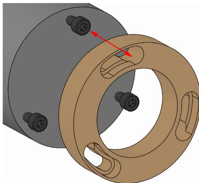
1. Das Wechselteil auf das Produkt aufsetzen, sodass der Schraubenkopf der Befestigungsschraube Wechselteil durch die Bajonettöffnung passt.
