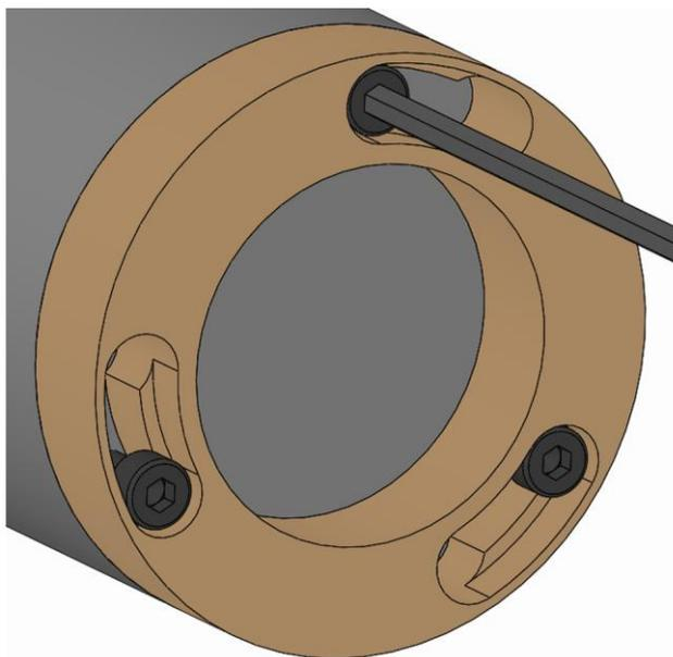
3. Die Befestigungsschrauben Wechselteil mit dem vorgeschriebenen Anzugsdrehmoment festziehen [siehe Kapitel »Schraubenanzugsdrehmomente«].
