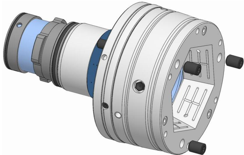
4. Die Gewindestifte Adaptionsspannmittel lösen und entfernen.
