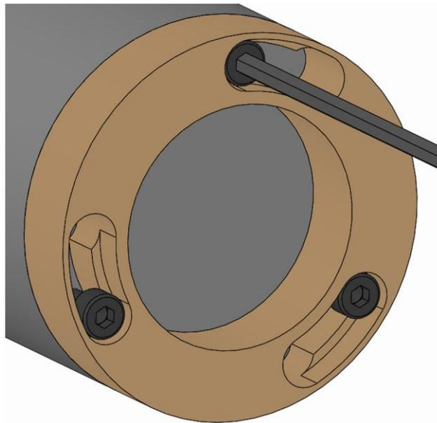
1. Die Befestigungsschrauben Wechselteil einige Umdrehungen lösen ohne diese zu entfernen.
