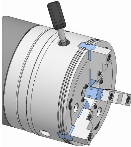
2. Den Ausklinkbolzen der Spannbacke mit dem Ausklink-schlüssel lösen.
