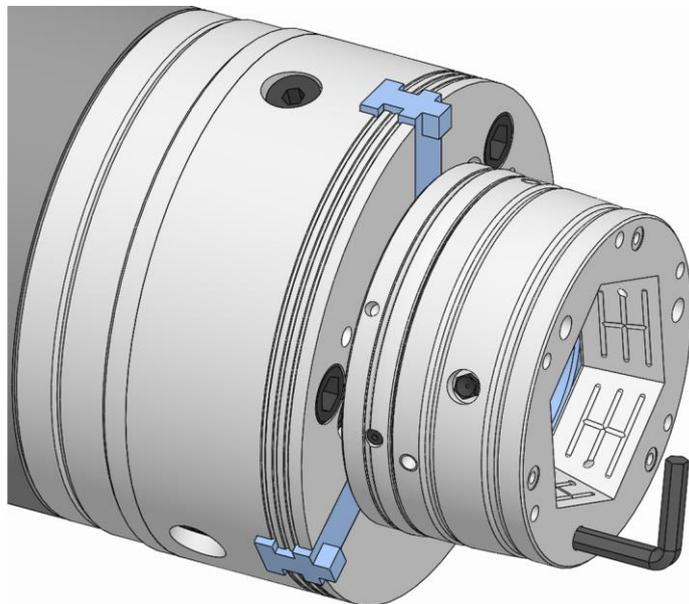
7. Die Befestigungsschrauben Adaptionsspannmittel einschrauben und diese mit dem vorgeschriebenen Anzugsdrehmoment festziehen [siehe Kapitel »Schraubenanzugsdrehmomente«].
