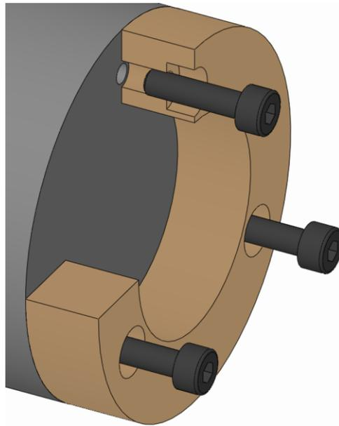
2. Die Befestigungsschrauben Wechselteil einschrauben und diese mit dem vorgeschriebenen Anzugsdrehmoment festziehen [siehe Kapitel »Schraubenanzugsdrehmomente«].
