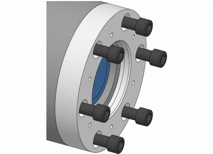
4. Die Befestigungsschrauben Spindel­flansch einschrauben und diese mit dem vorgeschriebenen Anzugsdrehmoment festziehen [siehe Kapitel »Schraubenanzugsdrehmomente«].
