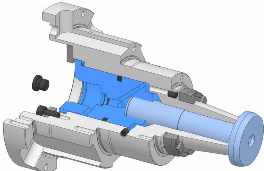
1. Die Verschlusschraube lösen und entfernen.
