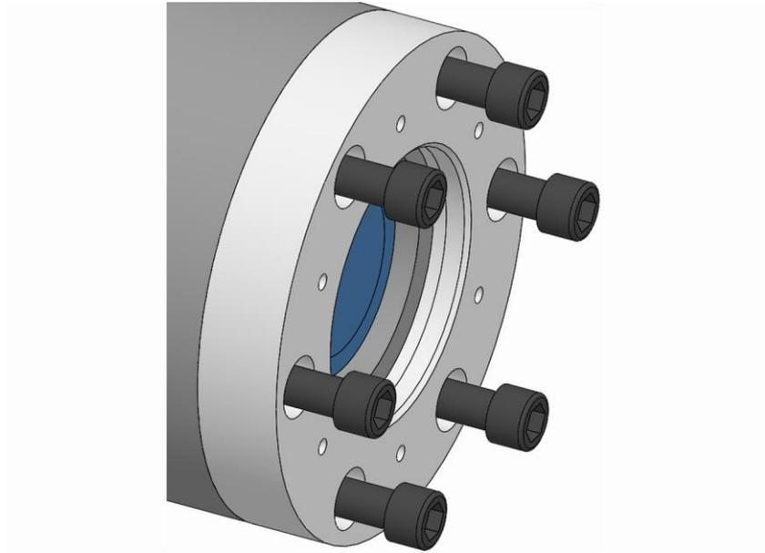
4. Die Befestigungsschrauben Spindelflansch einschrauben und diese leicht anlegen.
