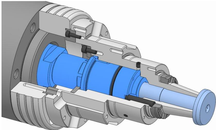
5. Die Funktionseinheit zurückdrehen, bis das Bohrbild am Spindel­flansch und der Funktionseinheit übereinstimmen.
