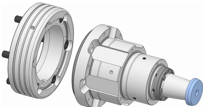
3. Die Funktionseinheit von dem Spindelflansch herunternehmen.
