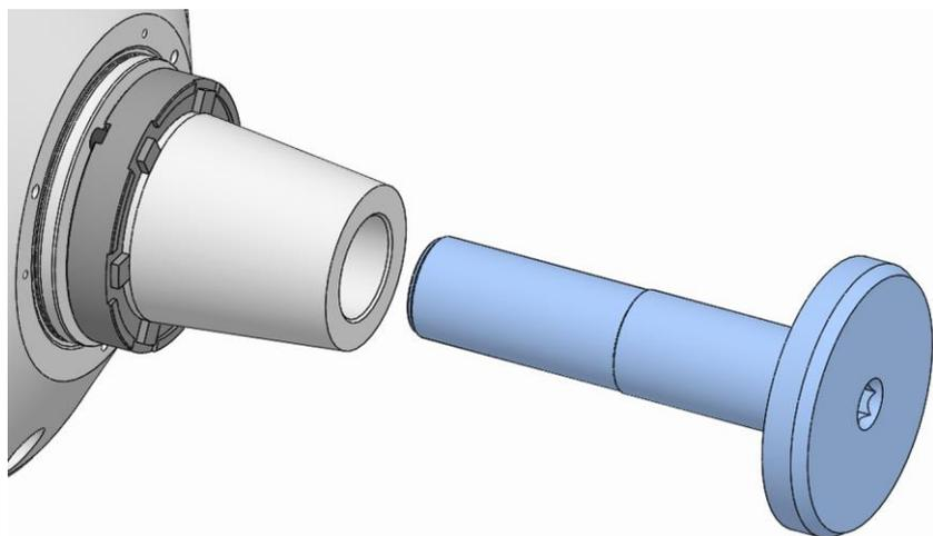
3. Den Zugbolzen lösen und entfernen. Dabei den Auswerferring gegen Herunterfallen sichern.
