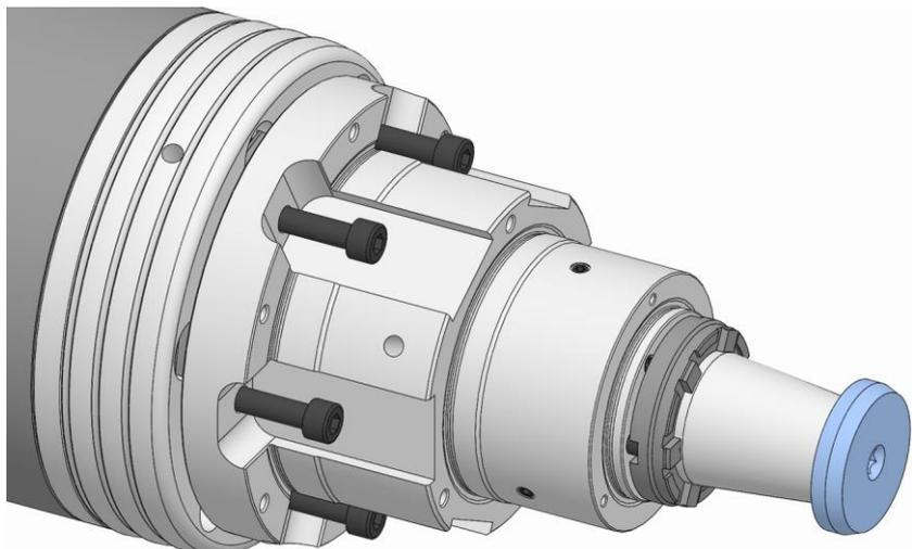
7. Die Befestigungsschrauben Funktionseinheit einschrauben und diese leicht anlegen.
