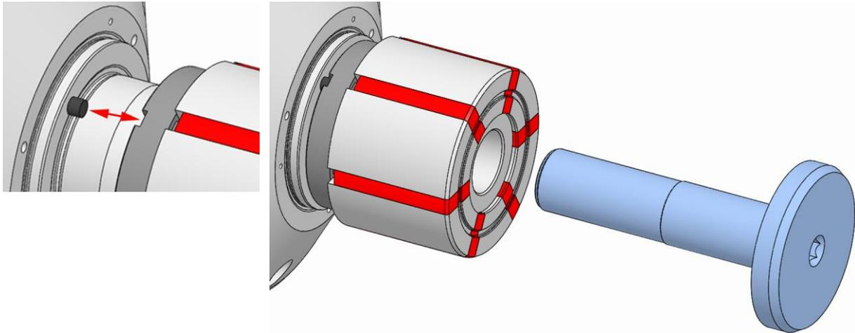
3. Den Zugbolzen lösen und entfernen. Dabei den Auswerferring und die Segmentspannbüchse gegen Herunterfallen sichern.
