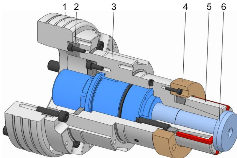
Der Spindel­flansch ist auf der Spindel der Maschine montiert.
