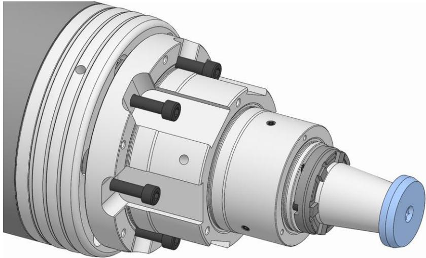
4. Die Befestigungsschrauben Funktionseinheit lösen und entfernen.
