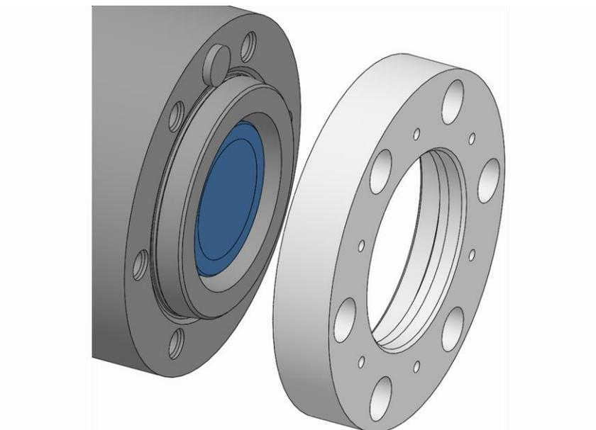
4. Den Spindelflansch von der Spindel der Maschine herunternehmen.
