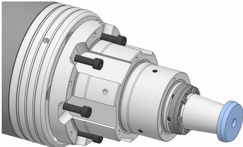
7. Die Befestigungsschrauben Funktionseinheit einschrauben und diese mit dem vorgeschriebenen Anzugsdrehmoment festziehen [siehe Kapitel »Schraubenanzugsdrehmomente«].
