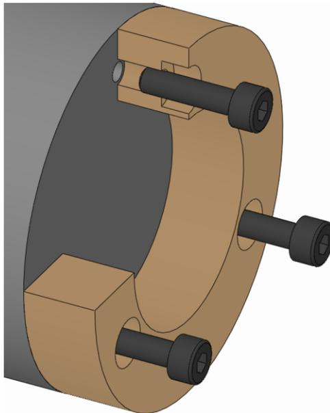
1. Die Befestigungsschrauben Wechselteil lösen und entfernen.
