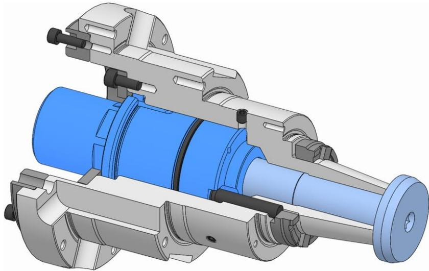
2. Die Befestigungsschrauben Ring Adaptionset einschrauben und diese mit dem vorgeschriebenen Anzugsdrehmoment festziehen [siehe Kapitel »Schraubenanzugsdrehmomente«].
