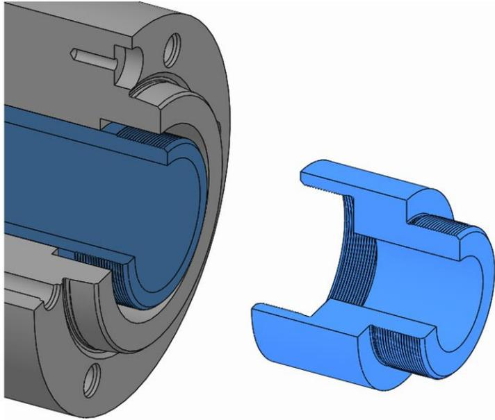
1. Wenn der Zugrohradapter auf das Zugrohr der Maschine montiert wurde, diesen über dessen Gewinde von dem Zugrohr der Maschine herunterschrauben.
