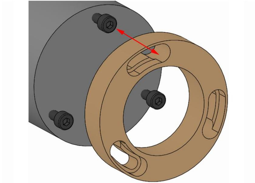
1. Das Wechselteil auf das Produkt aufsetzen, sodass der Schraubenkopf der Befestigungsschraube Wechselteil durch die Bajonettöffnung passt.
