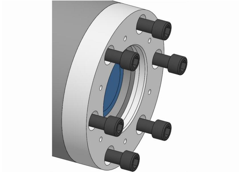
3. Die Befestigungsschrauben Spindelflansch lösen und entfernen.
