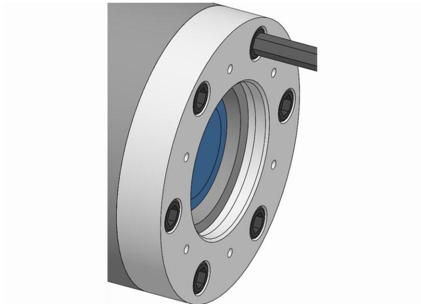
8. Die Befestigungsschrauben Spindelflansch mit dem vorgeschriebenen Anzugsdrehmoment festziehen [siehe Kapitel »Schraubanzugsdrehmomente«].
