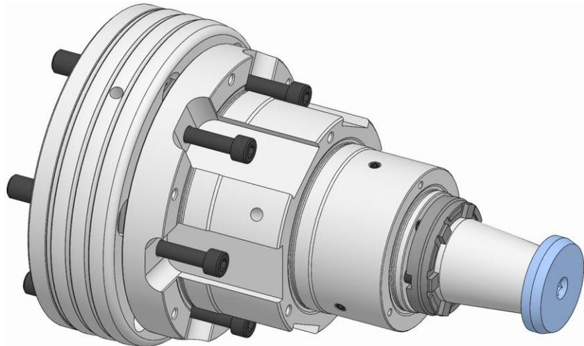
2. Die Befestigungsschrauben Funktionseinheit lösen und entfernen.
