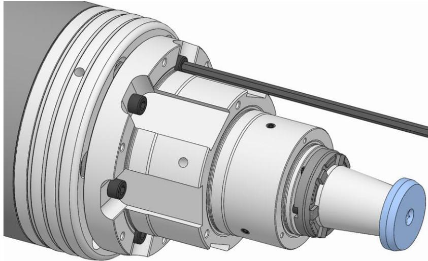
11. Die Befestigungsschrauben Funktionseinheit mit dem vorgeschriebenen Anzugsdrehmoment festziehen [siehe Kapitel »Schraubenanzugsdrehmomente«].
