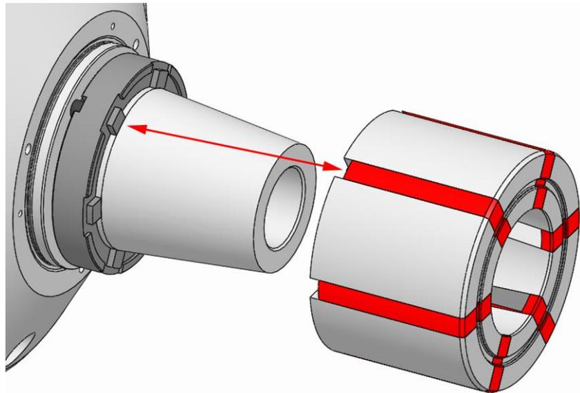
4. Die Segmentspannbüchse auf das Produkt aufsetzen. Dabei müssen die Schlitzte der Segmentspannbüchse in die Nasen des Auswerferrings eingreifen.
