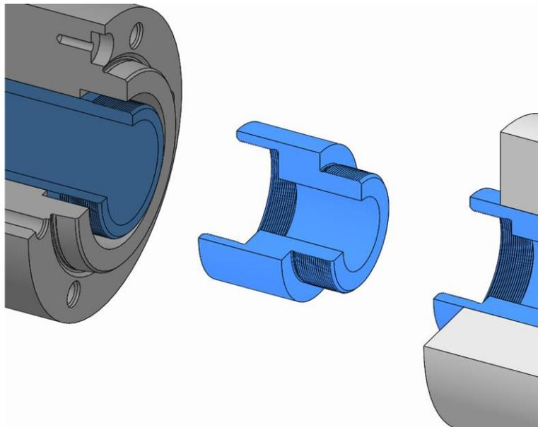
1. Den Zugrohradapter über dessen Gewinde in die Funktionseinheit einschrauben oder auf das Zugrohr der Maschine aufschrauben und festziehen.
