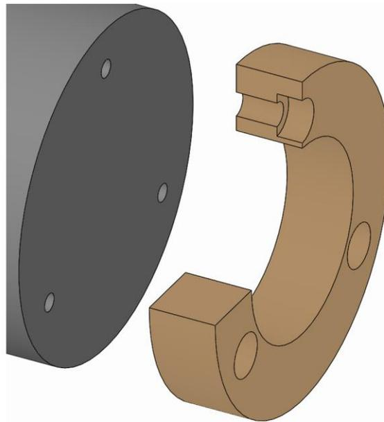
1. Das Wechselteil auf das Produkt aufsetzen.
