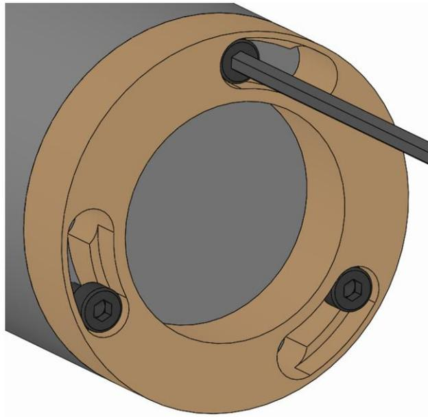
3. Die Befestigungsschrauben Wechselteil mit dem vorgeschriebenen Anzugsdrehmoment festziehen [siehe Kapitel »Schraubenanzugsdrehmomente«].
