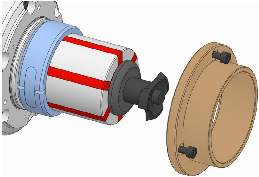
6. Die Abdrehhülse / den Werkstückanschlag über die Kupplungsschale auf das Produkt aufsetzen und befestigen [siehe Kapitel »Montage der Wechselteile«].
