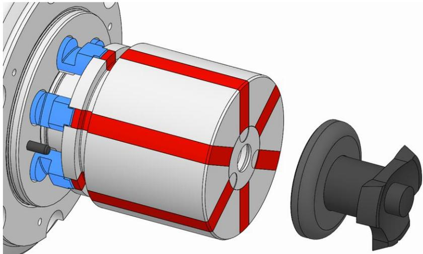
6. Die gegebenenfalls verwendete Wechselhilfe lösen und entfernen und die Segmentspannbüchse gegen Herunterfallen sichern.
