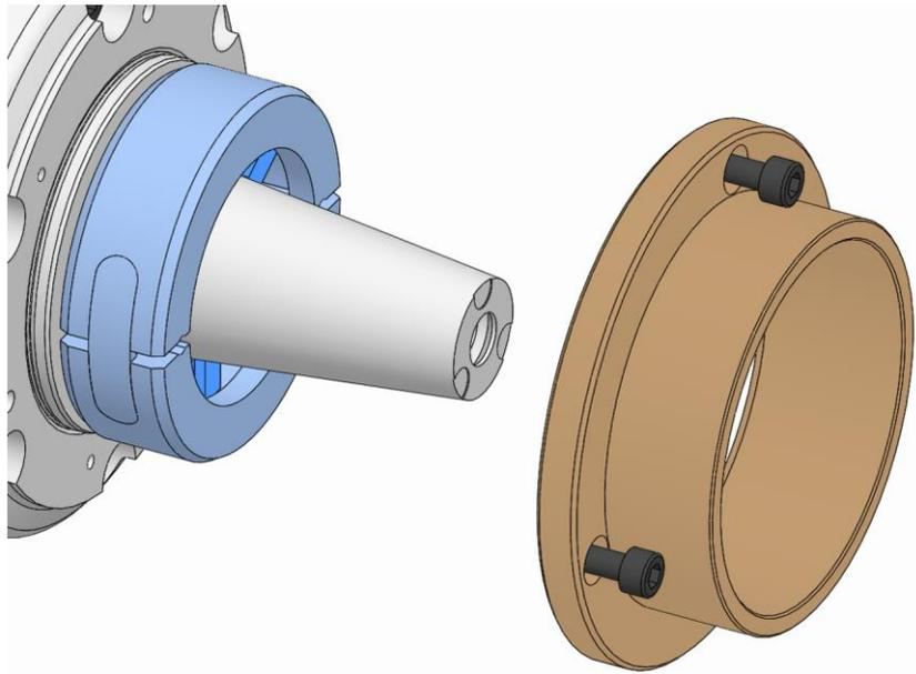
9. Die Abdrehhülse / den Werkstückanschlag über die Kupplungsschale auf das Produkt aufsetzen und befestigen [siehe Kapitel »Montage der Wechselteile«].
