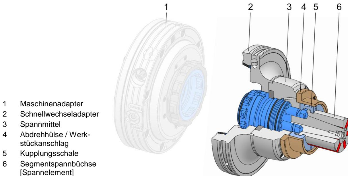
Der Maschinenadapter ist auf der Spindel der Maschine befestigt.
