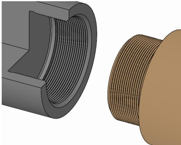
1. Das Wechselteil über dessen Gewinde in das Produkt einschrauben und festziehen.
