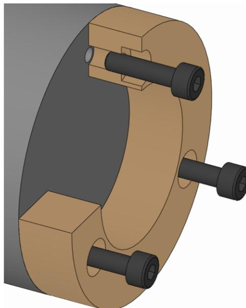
2. Die Befestigungsschrauben Wechselteil einschrauben und diese mit dem vorgeschriebenen Anzugsdrehmoment festziehen [siehe Kapitel »Schraubenanzugsdrehmomente«].
