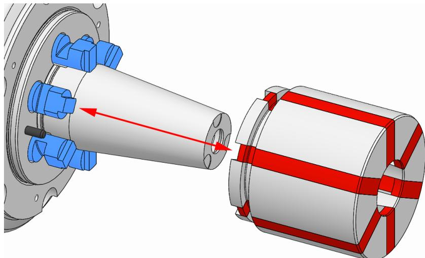
3. Die Segmentspannbüchse auf das Produkt aufsetzen und gegen Herunterfallen sichern. Dabei müssen die Schlitze der Segmentspannbüchse in die Nasen der Kupplung eingreifen.
