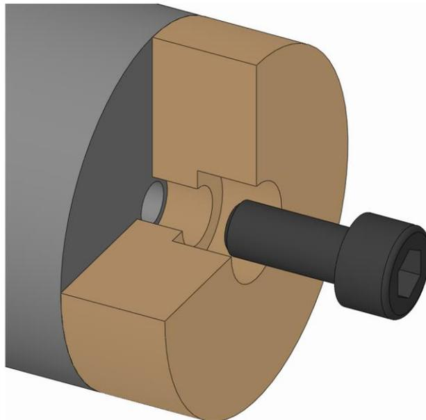
2. Die Befestigungsschraube Wechselteil einschrauben und diese mit dem vorgeschriebenen Anzugsdrehmoment festziehen [siehe Kapitel »Schraubenanzugsdrehmomente«].
