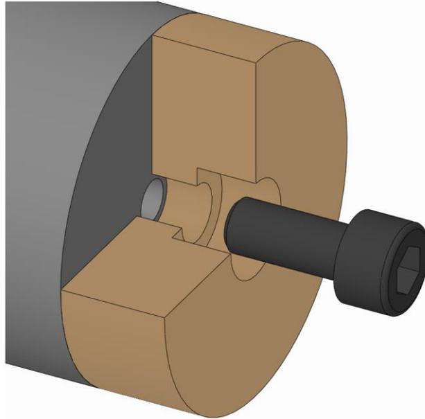
1. Die Befestigungsschraube Wechselteil lösen und entfernen.
