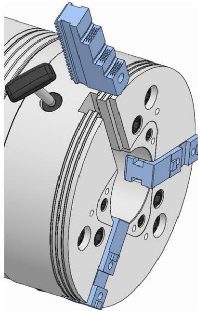
5. Die Spannbacke bis zur Markierungslinie einsetzen.
