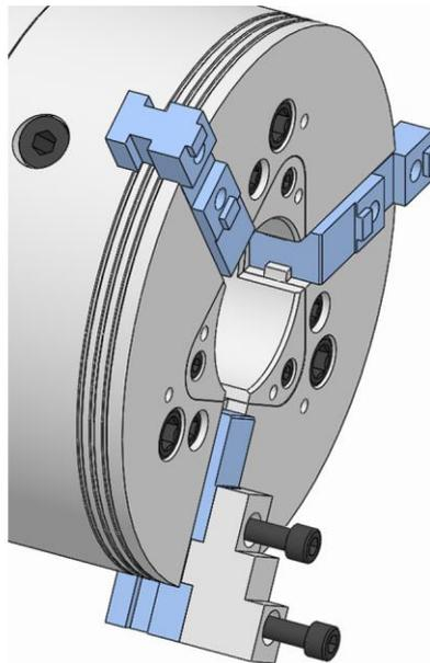
1. Die Befestigungsschrauben Aufsatzbacke lösen und entfernen.
