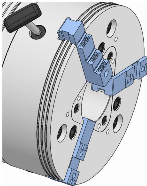
6. Den Auslinkschlüssel verdrehen, sodass die Verzahnung des Backenfutters in die Verzahnung der Spannbacke einrastet.
