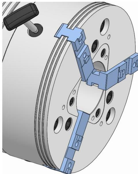
4. Den Auslinkschlüssel verdrehen, sodass die Verzahnung des Backenfutters in die Verzahnung der Spannbacke einrastet.
