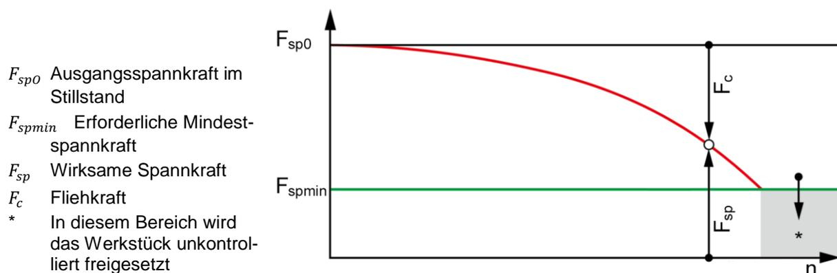
Die notwendige wirksame Spannkraft für die Zerspanung  $F_{sp}$  berechnet sich aus dem Produkt der Zerspanungskraft  $F_{spz}$  mit dem Sicherheitsfaktor  $S_z$ . Dieser Faktor berücksichtigt Unsicherheiten in der Berechnung der Zerspanungskraft. Laut VDI 3106 gilt:  $S_z \geq 1,5$ .
