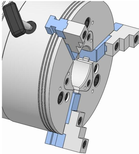
4. Die Spannbacke einsetzen und auf den gewünschten Durchmesser schieben.
