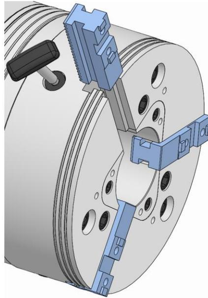
3. Die Grundbacke bis zur äußersten Markierungslinie einsetzen.
