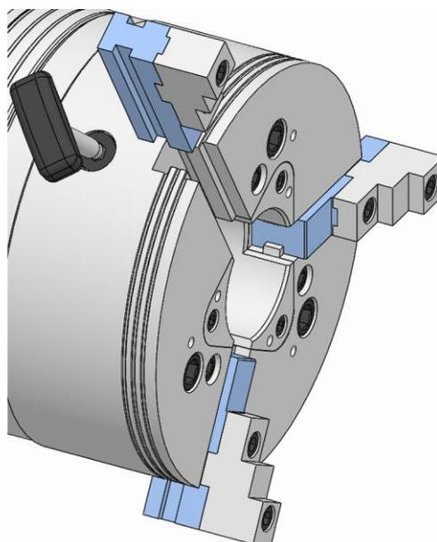
3. Die Spannbacke nach außen aus der Nut entfernen.
