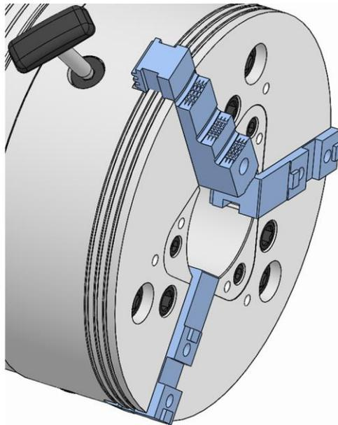
1. Die Keilstange mit dem Ausklinkenschlüssel entriegeln.
