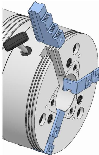
2. Die Spannbacke nach außen aus der Nut entfernen.
