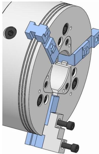
3. Die Befestigungsschrauben Aufsatzbacke einschrauben und mit dem vorgeschriebenen Anzugsdrehmoment festziehen [siehe Kapitel »Schraubenanzugsdrehmomente«].
