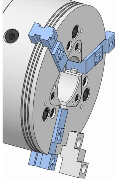
2. Die Aufsatzbacke mit dem Kreuzversatz in die Nut der Grundbacke einsetzen.
