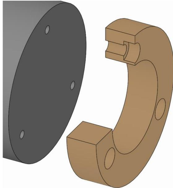
1. Das Wechselteil auf das Produkt aufsetzen.
