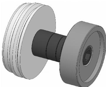
Das Anschlagssystem vario part funktioniert nach demselben Prinzip wie ein Endmaßkasten und lässt sich in 1 mm Schritten mit Präzisionsscheiben in der Höhe abstimmen.
