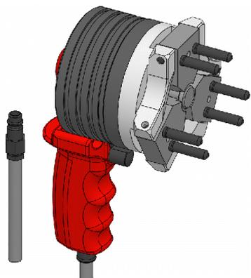
Die Stifte der Wechselvorrichtung werden in die Wechselbohrungen im Spannkopf eingesetzt. Die Wechselvorrichtung wird mittels Druckluft betätigt. Je nach Baugröße ist die Wechselvorrichtung für eine Ein- oder Zweihandbetätigung ausgelegt. Der Spannkopf ist fest in die Wechselvorrichtung eingespannt und kann mit Hilfe der Wechselvorrichtung in das montierte Spannmittel eingesetzt werden.
