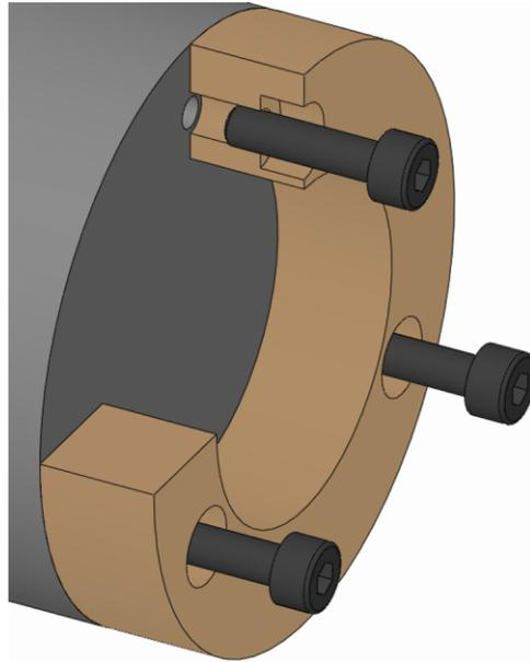
1. Die Befestigungsschrauben Wechselteil lösen und entfernen.
