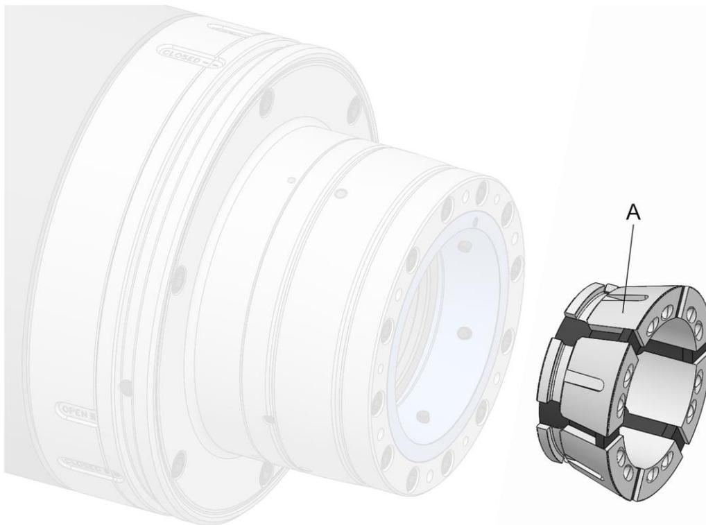
A Spannkopf [Spannelement]
