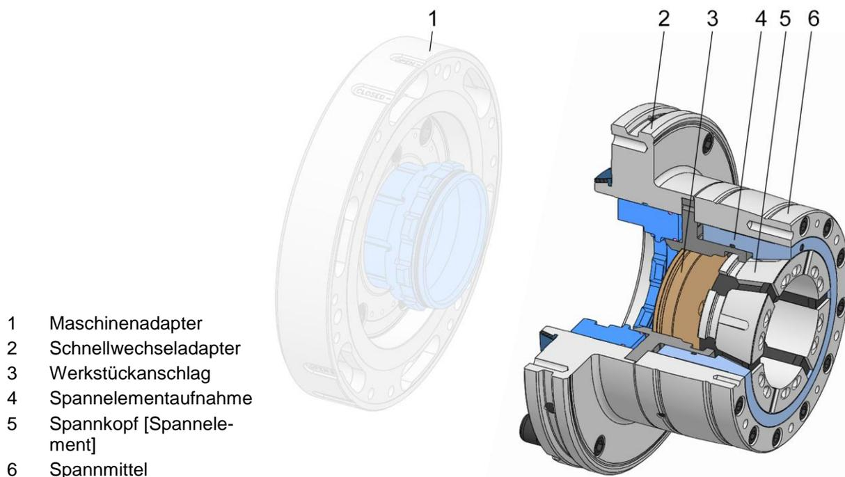
Das Spannmittel kann sowohl als Durchgangsfutter für die Stangenbearbeitung als auch als Anschlagfutter eingesetzt werden.
