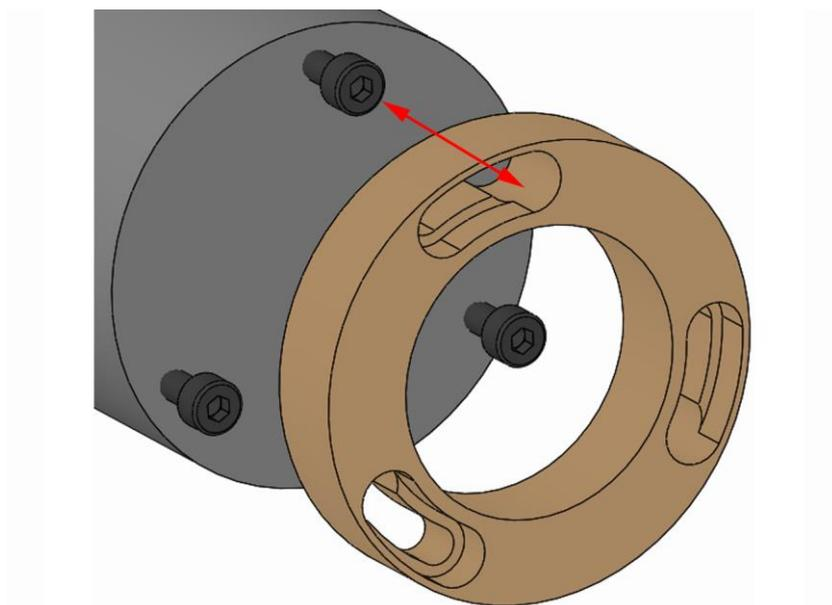
1. Das Wechselteil auf das Produkt aufsetzen, sodass der Schraubenkopf der Befestigungsschraube Wechselteil durch die Bajonettöffnung passt.
