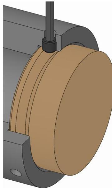
1. Die Klemmschrauben Wechselteil herausdrehen bis sich das Wechselteil herausnehmen lässt.
